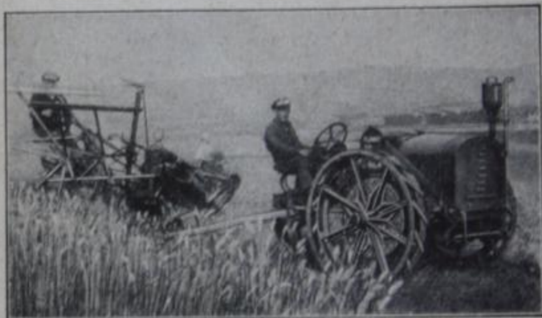
Der Flader-Motorpflug als Schlepper beim Bindemähen.
