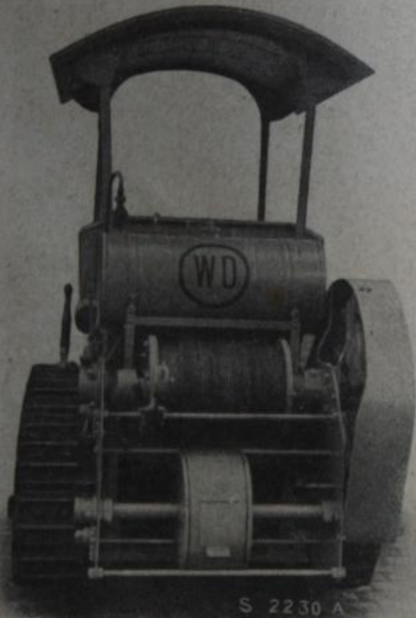
WD-Kettenschlepper 28 PS mit abnehmbarer Seilwinde für Forstarbeiten.
